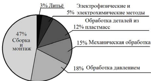
Рис. 4.1. Трудоёмкость основных технологических процессов изготовления деталей РЭС
