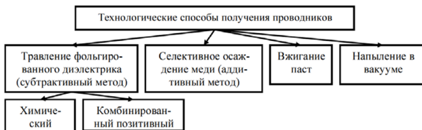
Рис. 2.4. Способы получения проводников
