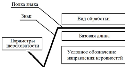
Рис. 7.4. Схема условного обозначения шероховатостей
