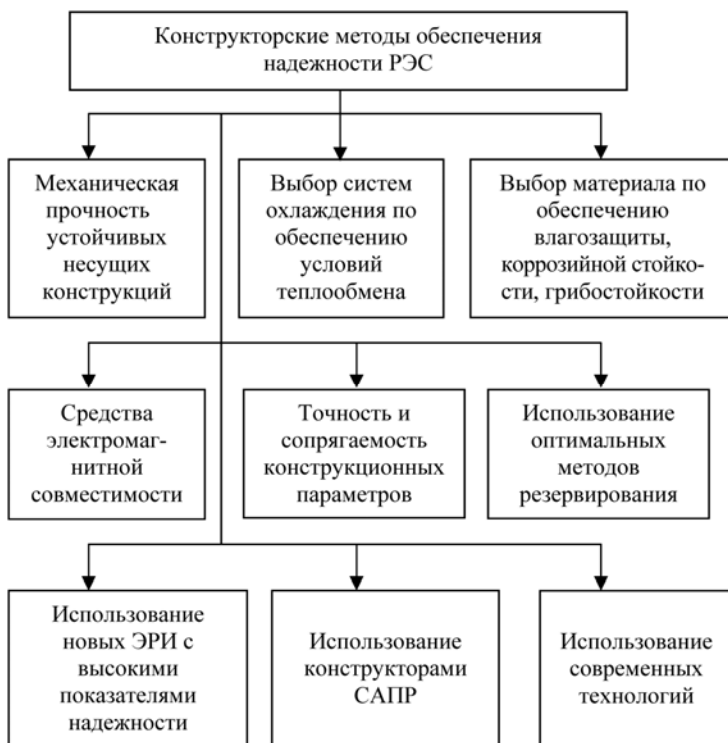
Рис. 6.6. Конструкторские методы обеспечения надёжности РЭС
