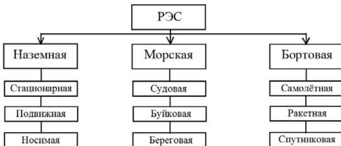
Рис. 1.1. Классификация РЭС по классам и группам исполнения
